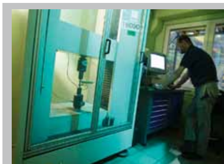
Giettechnische controles (treksterkte - zwavelbepaling - ultrasoon controle ...) worden uitgevoerd met eigen meetapparatuur.
